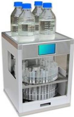
加拿大博朗科技（Promo Chrom Technologies Ltd.）开发的 SPE-04+四通道全自动固相萃取仪处理样品速度极快，应用范围广的样品前处理平台。由于采用管路集成技术，将复杂的管线和阀集成为一至二个模块，仪器结构得以大幅度简化，简化的结构不仅使得仪器更轻巧，而且提高了运行的稳定性。
