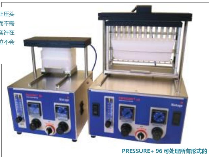
**PRESSURE+ 96** 可处理所有形式的 96 孔板，包括广泛使用的 1 mL 和 2 mL 阵列式 96 孔板，从而不需要采购额外的垫片。
